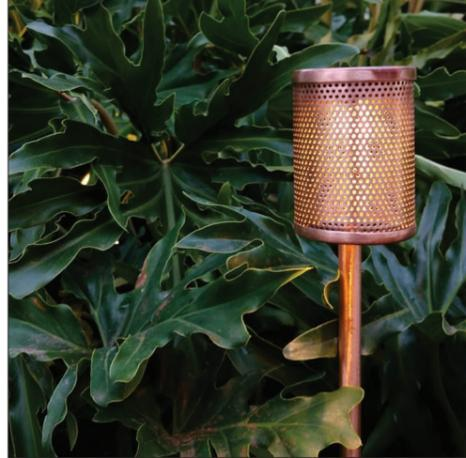
Balizador cilíndrico com corpo em metal perfurado, com versões e sobrepor ( Tamiz SO) e espeto (Tamiz ES- haste com 68 cm). Dotado de LED com 100 lumens e emissão difusa. LEDs com cor de emissão em Âmbar, Branco 2700K e Branco 5000K. Índice de proteção IP 64 (ambientes internos e externos). Alimentação com driver Bivolt (127V/220V) remoto. Disponível em Cobre Natural ou Alumínio com pintura eletrostática em Branco, Corten, Grafite, Prata e Preto. Consumo de 3W.
